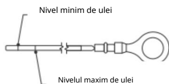
Figura 5-1 Indicator de nivel de ulei
